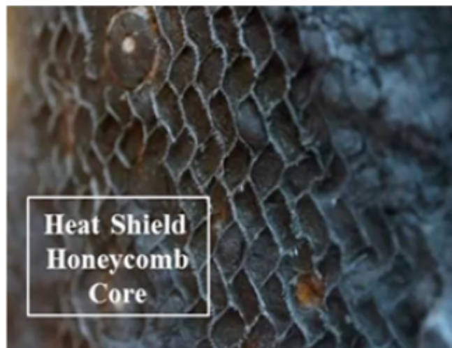
图3 一种防热大底的热防护结构形式：蜂窝增强材料+轻质烧蚀材料（图片来源：网络）
