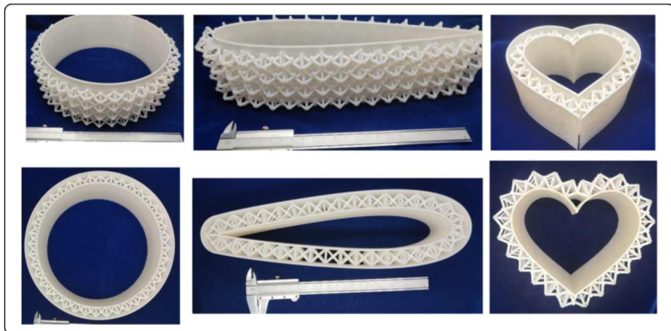
图9 大尺寸三维点阵嵌锁-铰接制备技术[5]
