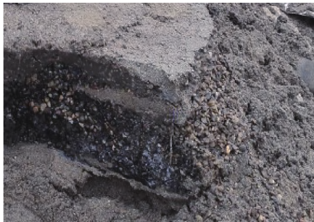
图 3 注浆材料地层填充情况
