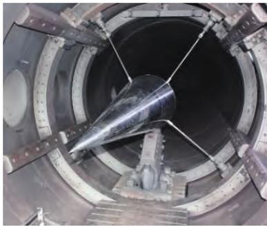
图4 风洞中的大尺度圆锥模型
