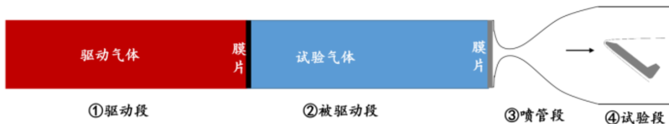
图3 高焓激波风洞运行原理
