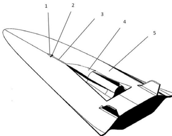
1. 一种两级入轨水平级间分离的飞行器,其特征在于,包括助推级飞行器和轨道级飞行器,所述轨道级飞行器贴合在所述助推级飞行器的上表面;
