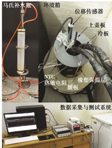
图 2 膨胀土冻胀试验系统
