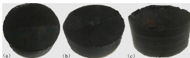
图 3.3 多层阻抗梯度变化吸声材料的样品实物图
