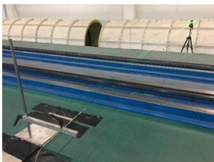
图 6 光电测速系统
