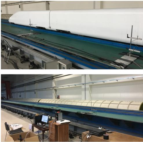
图 1 高速列车动模型试验平台
