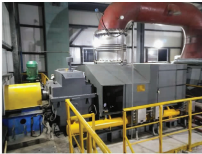
图2 汽电双驱窑尾高温风机系统
