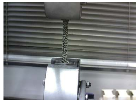
图 6 准静态拉伸实验
