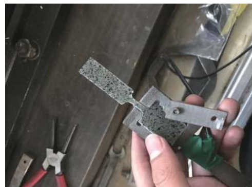
图2 动态拉伸试验夹具
