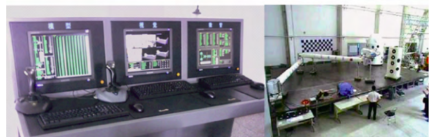
图 4 某大型空间机械臂地面试验的遥操作系统实例
