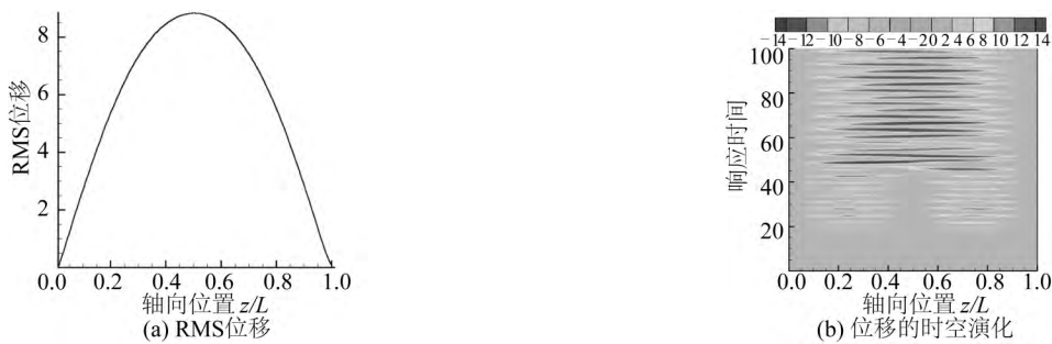
图7 垂荡频率 \omega_0 = \omega_2 时立管响应
