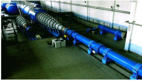
图6 JF12 大尺度长试验时间爆轰驱动激波风洞
