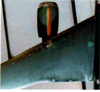
图20 F6-WBPN 翼根涡流实验流线
