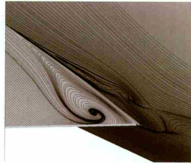
图25 WENO5 F6-WBPN 机翼根部涡流流线
