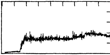
(a) JF10 喷管流场的皮托压力曲线
