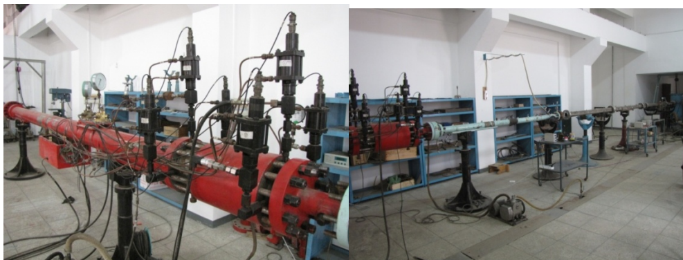
图 1 爆轰驱动激波-膨胀管: JF-16 (LHD)
