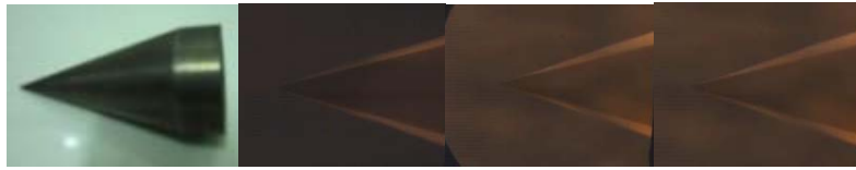
图 11 JF-16 模型试验照片( u_\infty=8.1 km/s) [23]
