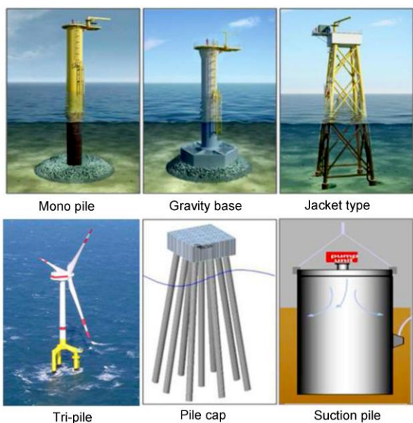
图 2 (网络版彩图)典型固定式支撑结构(参见文献[15]图 5)
