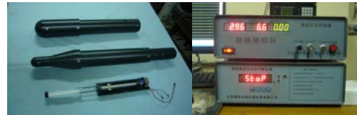
图 7 溢流模型与同步控制器
