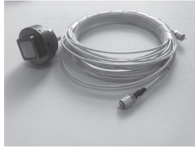
图 5 摩阻天平实物
