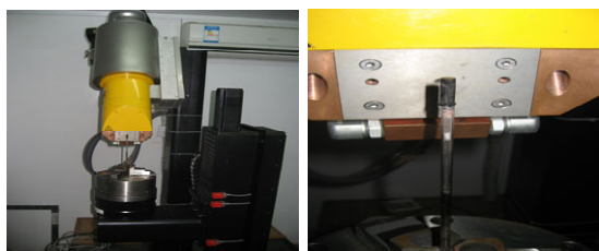
图 1 \mu CT225kVFCB 型显微 CT 实验系统
