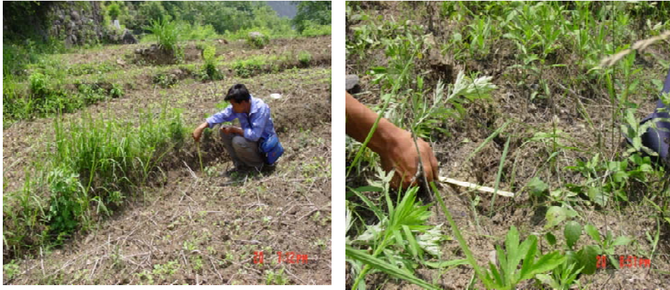
图 4-9 滑坡体下部旱田由于变形形成的陡坎及裂缝
