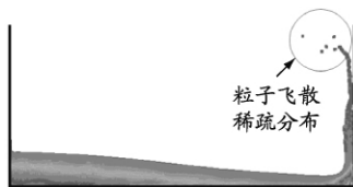
图 1 在 SPH 方法模拟溃坝过程中波前撞击固体障碍时的粒子飞散和稀疏分布
