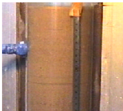
图 1 冲击后出现的横断裂缝 Fig.1 Horizontal cracks
