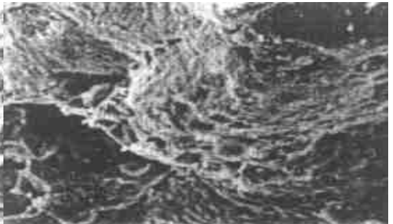
图 4 韧窝断裂形貌(断口)
