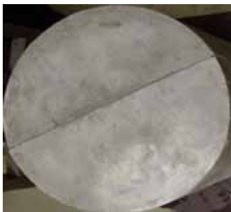
图 1 预制剖面水泥试样照片
