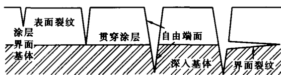
图 1 涂层的一种典型破坏模式
