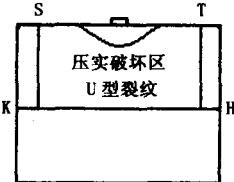
图 4 水泥块的破坏区域示意图
