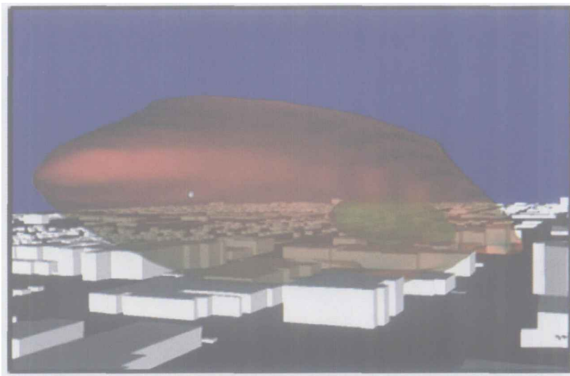
图 4 应用嵌套模型模拟俄克拉何马城中有毒蒸汽羽流的运动. 大尺度、中等尺度和城市尺度(计算流体力学) 模型同时显示. (在亚利桑那州立大学决策电教室陈列. 该电教室是复杂的社会、经济和自然过程可视化, 并进行研究和决策的地方)
