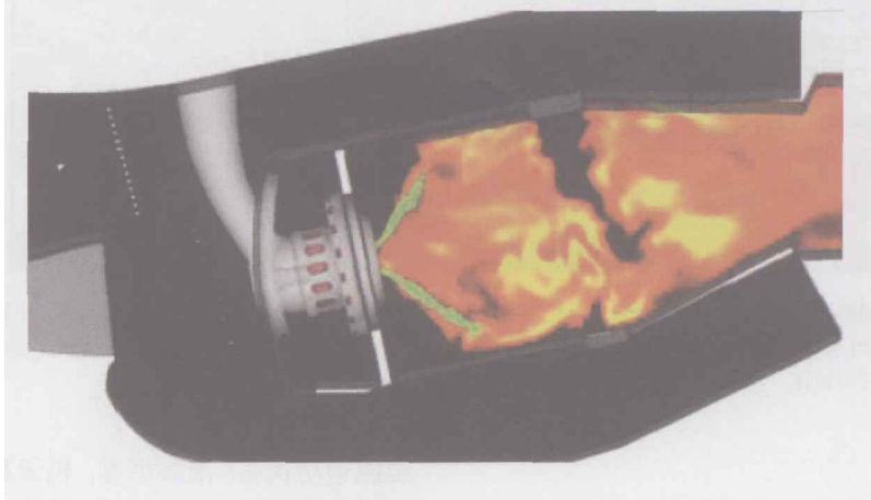
图 6 气体涡轮燃烧室的计算机模拟, 显示燃料的喷雾 (绿色). (Stanford University)
