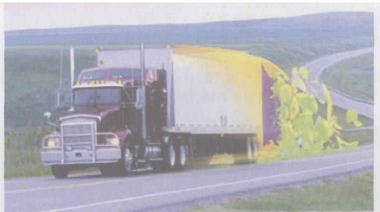
图 5 卡车尾部湍流尾迹的计算机模拟. (Fluent, Inc.)
