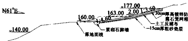
图 5 II-II 剖面护坡工程设计图
